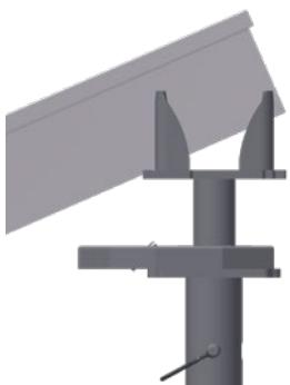
5.) Pričvrstite prvi oplatni element na stropne podupirače 1 + 2.
